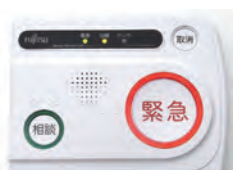
緊急通報システム
