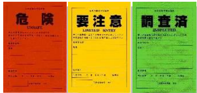
建物の応急危険度判定のステッカー
