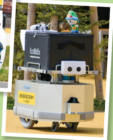
今回の実験で使用した自動 配送ロボット「ロジー S(上)」 と「ロジー SS(右)」
