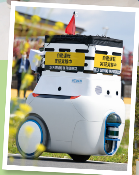
今回の実験で使用した自動 配送ロボット「ロジー S(上)」 と「ロジー SS(右)」
