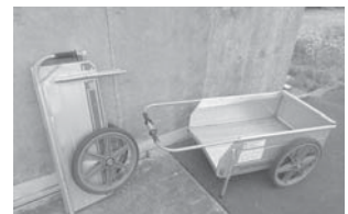
アルミ製折りたたみ式リヤカー
