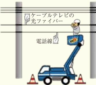
**■幹線工事**…既存の電柱（東京電力・NTT）に設置された電力線と電話線の間にケーブルテレビの光ファイバーケーブルを敷設します。電柱位置によってはみなさんの土地の上空にケーブルが敷設される場合がありますが、あくまでも既存の電力線の下に敷設いたします。
