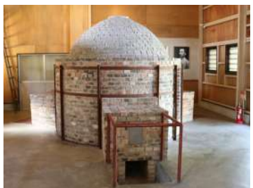
三方茨口倒焰式丸窯（板谷波山記念館内）田端の工房で実際に使われていた窯や、ロクロ台、各種の道具など、波山芸術の生まれた場が再現されています。
