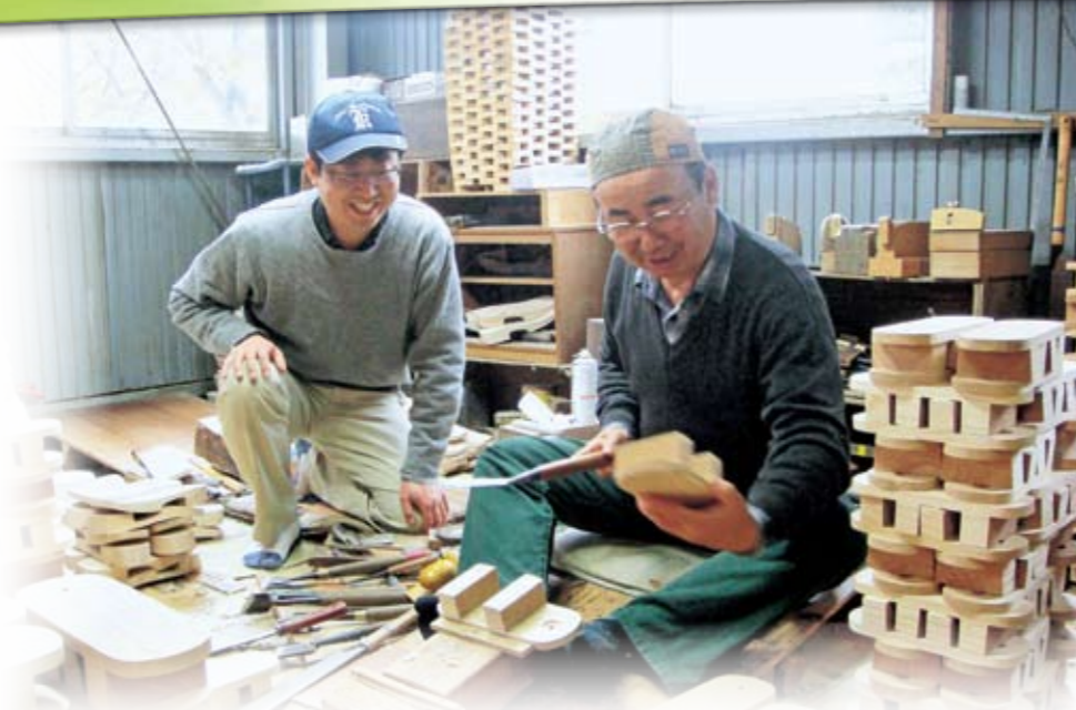
三代目の猪ノ原武史さん(左)と、二代目の猪ノ原昭廣さん。桐材の伐採、製材、輪積み乾燥、糸鋸による組みはがし作業、鼻回し、ダゴ入れ、穴開け、艶出しミガキなどの工程を経て、鼻緒スゲ作業で完成する。写真は手作業による仕上げ作業。
