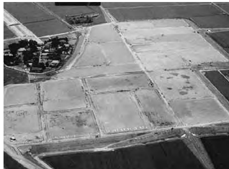
▲激特事業によって完成した『母子島遊水地』（上）洪水時に小貝川の水かさがある一定の高さになると、ここに水が溜め込まれます。右下は造成中の『旭ヶ丘』。左下は安心して暮らせる旭ヶ丘の街並み。
